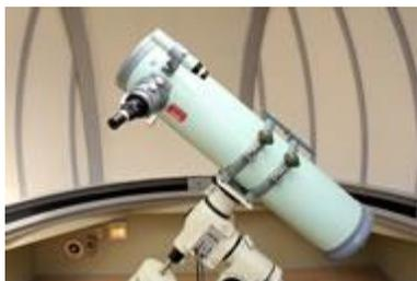
ハシ MT-160 という直径 160mm 焦点距離 1000mm の反射望遠鏡で扱いやすいそうです。
