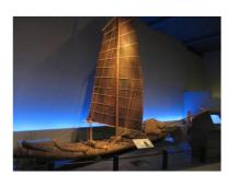
イです。8本の竹を東ねた船体の長さは5m,高さは7mもあります。遠 浅の海で接岸できず沖合に停泊している船と波止場の間を,乗客や荷 物を運んでいたそうです。今は,竹の代わりに塩化ビニルのパイプを 組み,帆の代わりにエンジンで動くものが使われているということで した。
