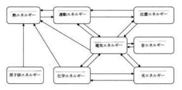
上の図はエネルギーの移り変わりを示したものです。電気エネルギーを運動エネルギーに変えるモーター、運動エネルギーを電気エネルギーに変える発電機、それはどの矢印にあたるのか分かりますか。マイクロホンやスピーカーはどうですか。そのほかの矢印は何を表しているのでしょうか。考えてみてください
