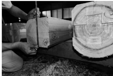
▲写真⑭ 大入れ仕口の計測
