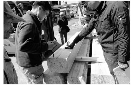
▲写真⑩ 含水率の計測
