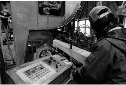
▲写真⑥ 帯鋸による製材
