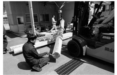
▲写真⑫ 打撃法によるヤング係数の計測
